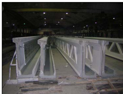
Travi impermeabilizzate con Icooper
